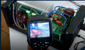
Die Wärmebildkamera zeigt entstehende Wärme und ihre Ableitung beim Genesis
